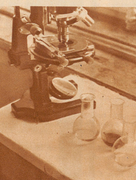
Bei der Titrationsmethode tritt in einem bestimmten Moment der Reaktion ein Farbumschlag ein, der den vorhandenen Alkohol berechnen läßt. Das mittlere der drei Kolbchen zeigt bereits den Farbumschlag; es ist gelb, während die anderen Kolbchen noch blaugrünlich sind
