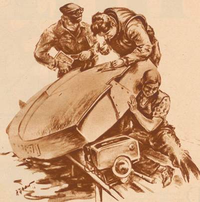
Das Heftpflaster. Ein Loch an der untern Backbordseite wird in einer Regatta-Pause mit Kistendeckeln zugemlickt
