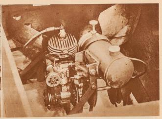
Der Beweis, daß Günther Hangl sein Auto nicht mit den Füßen tritt, sondern daß er einen Zweitaktmotor von 2 Pferdekräften samt Getriebe und Kupplung in seinen Wagen montiert hat
