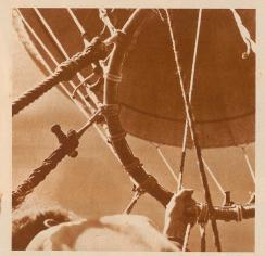
Blick vom Korb aus nach oben in die Seile und zum Ring, der den Korb trägt. Eine Hand hält die Ventilleine. Ziehen heißt Gas abgeben, also: Fallen
