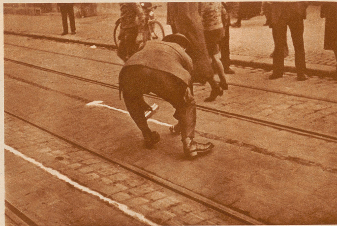
Für die Tatbestandsaufnahme ist die deutliche Kennzeichnung der Brems- und Gleitspuren des verunglückten Autos wichtig. Der Zeichner der Alarmgruppe markiert die Bremspuren mit Gips
