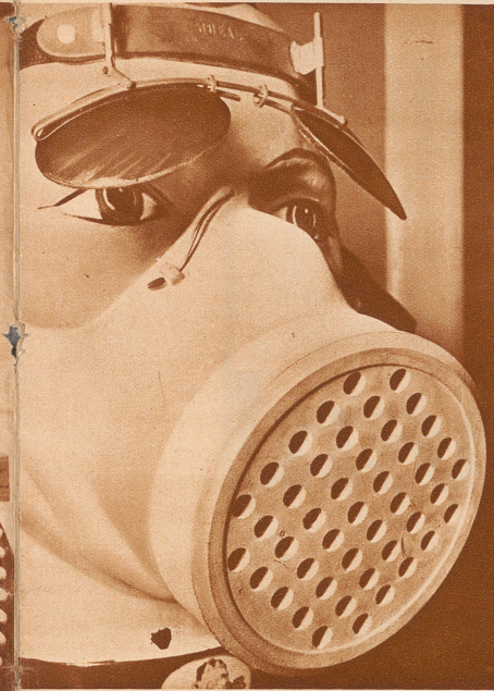
Grausig zum Ansehen, in Wirklichkeit aber die einfachste aller Masken: Die «Degea»-Gesteinstaubmaske. Sie wird von Grubenarbeitern und ganz allgemein überall dort gebraucht, wo gesprengt wird
