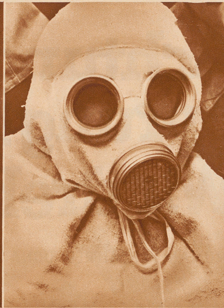
Eine Asbest-Staubmaske, die in den Fabriken zum Schutz gegen glühende Staubteilchen verwendet werden. Sie trägt den Uebernamen «Der Polarbär»
