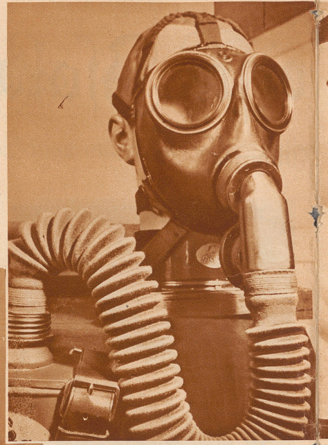
Eine Kohlenoxydmaske, verwendet in Gaswerken, in Rohrnetzbetrieben, bei der Feuerwehr, auf der Eisenbahn in Tunnels und Stollen
