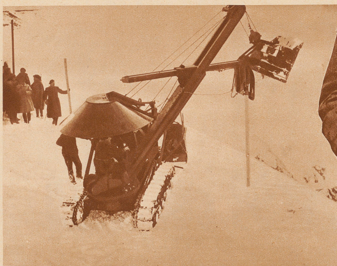
Internationaler Schneepflug-Wettbewerb. An zwei tiefverschneiten Pässen der Alpes Maritimes in Süd-Frankreich fand in diesen Tagen der 3. Internationale Schneepflug-Wettbewerb statt. Bild: Ein Schneepflug, der gleichzeitig als Schneebagger benutzt werden kann, in Tätigkeit
