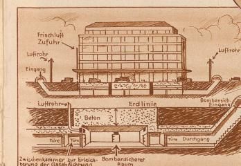
Schematische Darstellung eines bombensicheren Unterstandes, wie er unter schon bestehende Gebäude gebaut werden kann
