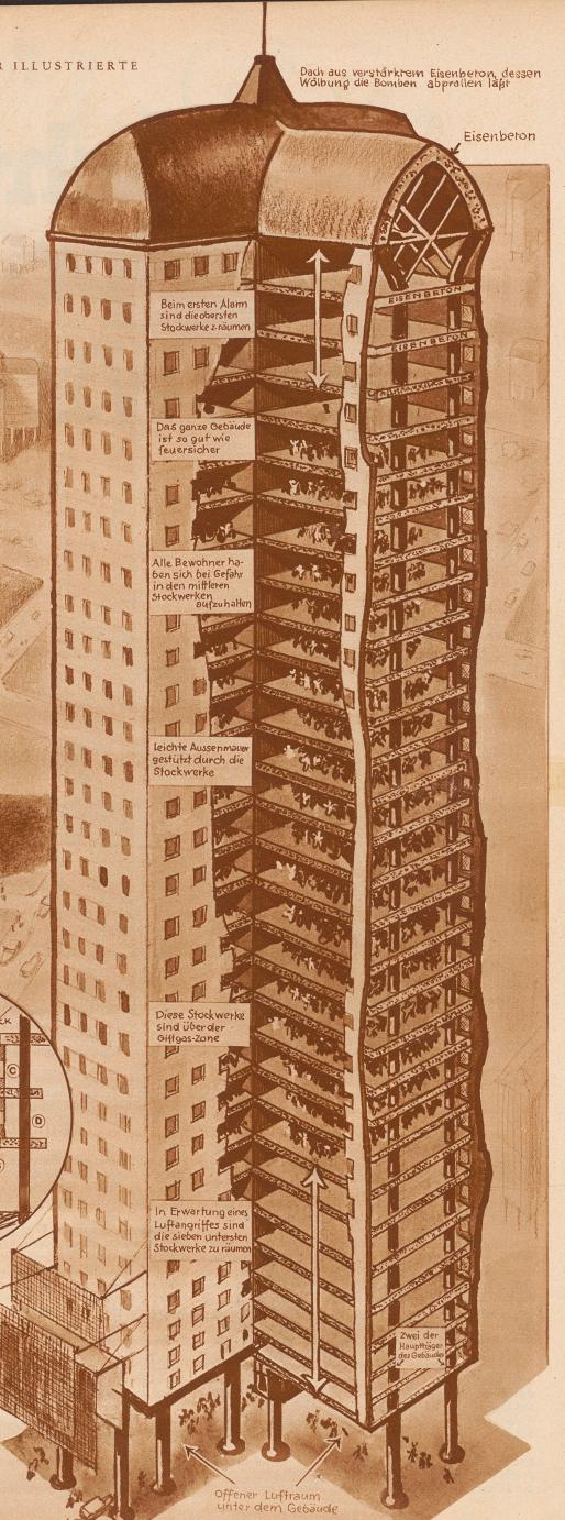
Dach aus verstärktem Eisenbeton, dessen Wölbung die Bomben abprallen lässt
