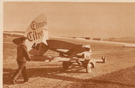
Vor dem Start in Dübendorf. Das Farnersche Segelflugzeug liegt auf einem leichten Wagen. Der Schlepper zieht Wagen und Segelflieger über die Piste. In die genügende Abfluggeschwindigkeit erreicht, dann erhebt sich der Segler von seiner Unterlage und steigt in sein eigentliches Element empor. Die verlassene Karre bleibt — sozusagen traurig — zurück
