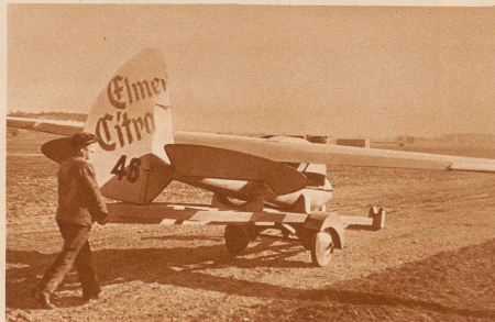
Vor dem Start in Dübendorf. Das Farnersche Segelflugzeug liegt auf einem leichten Wagen. Der Schlepper zieht Wagen und Segelflieger über die Piste. In die genügende Abfluggeschwindigkeit erreicht, dann erhebt sich der Segler von seiner Unterlage und steigt in sein eigentliches Element empor. Die verlassene Karre bleibt — sozusagen traurig — zurück
