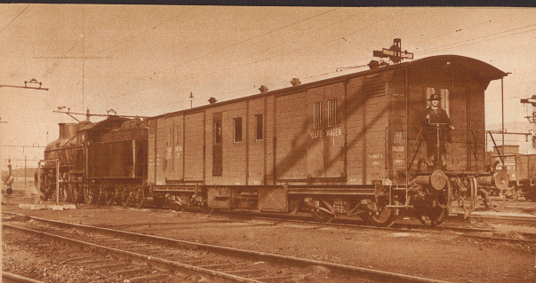
Auf allen größeren Bahnhöfen der Schweiz stehen Hilfswagen mit Dampfmaschinen fahrbereit, und zwar so, daß sie ohne große Rangierbewegungen nach Bedarf sofort abfahren können
