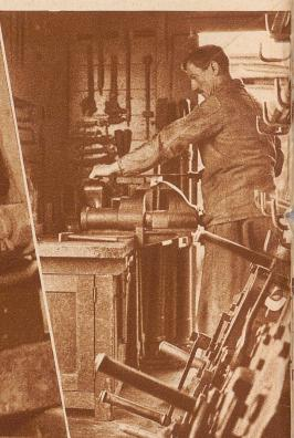
Gerätesatz des Hilfswagens. An der Werkbank können an Ort und Stelle notwendige Zurichtungen von Material vorgenommen werden. Im Vordergrund eine Reihe massiver Puswinden
