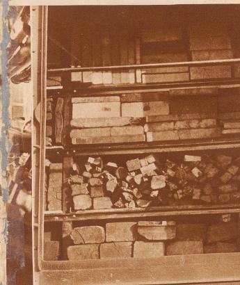
Im zweiten Gerätesatz des Hilfswagens werden schwere Bleiblocke mitgeführt, da es in der Regel notwendig ist, auf dem mehr oder weniger klassischen und geschotterten Bahnhörper eine feste Unterlage zu erstellen
