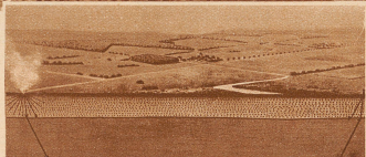
Schematische Darstellung dieser neuen Forschungsmethode: Links die Explosion, rechts der Seismograph. Das dazwischen liegende Gebiet muß von den Erschütterungswellen durchlaufen werden. Die punktierte und die einheitlich graue Fläche bedeuten, daß die Erde hier in verschiedenen Tiefen aus verschiedenen Ablagerungen besteht. An der Trennungsschicht wird die Erschütterungswelle, die sich nicht nur geradeaus, sondern auch nach unten fortplant, gebrochen. Auf der vom Seismographen aufzeichneten Kurve erscheint eine derartige Brechung oder die Trennungslinie zweier verschiedener Bodenschichten als Knick, aus dem man dann errechnen kann, in welcher Tiefe sich die verschiedenen gesuchten Bodenschätze befinden
