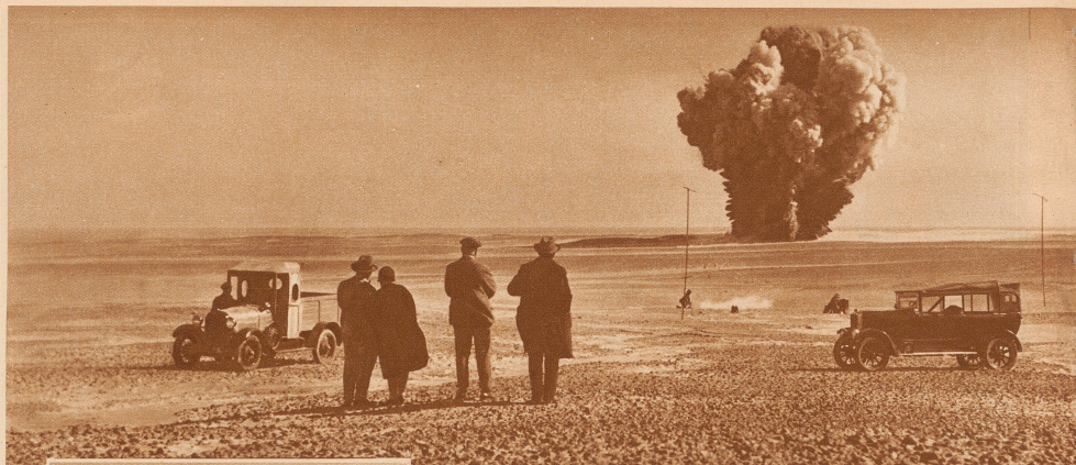
Die Explosion der Dynamitladung, die das künstliche Erdbeben hervorruft und den Seismographen zum Ausschlag bringt
