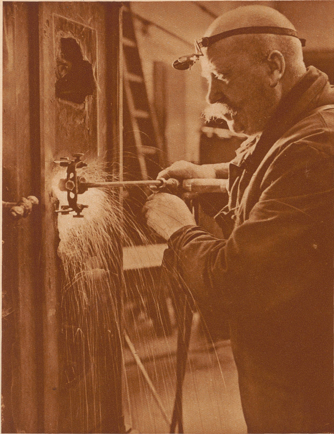
1932: Die neueste Erfindung der Geldschrankknacker, die Fernholzlampe. Sie ist das gefährlichste und gefürchtetste Einbruchsmittel. Die sehr großen, schwerfälligen Wasserstoff- bzw. Azetylenbehälter wurden durch sie hinfällig. Die zum modernen Einbruch nötigen Werkzeuge lassen sich heute bequem von einem einzigen Mann transportieren. Die mit der Fernholzlampe erzeugte Schneidetemperatur beträgt über 2800 Grad
