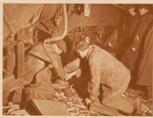
Schwierige Schweißarbeit an der schwerbeschädigten Lokomotive des Zürcher Zuges. Die Verschachtelung der Lokomotiven und der einzelnen Wagen war so stark, daß man sie mit Schweißapparaten angehen mußte, um sie voneinander zu trennen und ins Innere einzudringen
