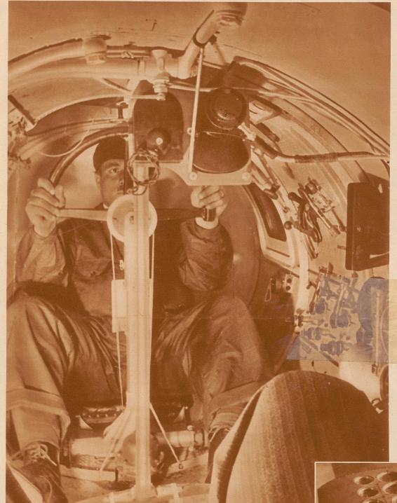
Das Innere der Kabine des Stratosphärenflugzeuges. Rechts die Hebel der drei großen Motorkompressoren, die bis 5000, 10 000 und 15 000 Meter Höhe nacheinander eingeschaltet werden. Der Raum ist 2 Meter lang. Die beiden Insassen der Kabine, Pilot und Mechaniker, oder Pilot und Beobachter, sitzen einander gegenüber.
