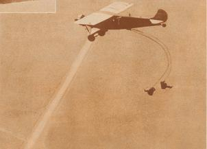
So sieht der «Absprung im Sessel» aus. Die beiden dunklen Linien sind die Seile der Fallschirme, die unten an den Sitzen angebracht sind. Jetzt sind sie noch mit dem Flugzeug verbunden. Bald aber werden sie zerreißen und in dem Augenblick entfaltet sich der Fallschirm
