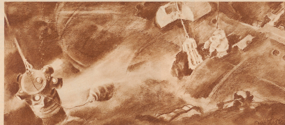
Die stählerne Beobachtungskammer (links) taucht ins Meer. In ihr steigt der Taucher bis zum Wrack der «Egypt». Ist er auf dem Meeresgrunde angelangt, folgt der Hebeapparat nach und greift nach Weinungen, die der Taucher telephonisch nach oben gibt, in die Schatzkammer der «Egypt» ein. Wegen der starken Strömung ist die ohnehin sehr schwere Beobachtungskammer noch mit einem birnenförmigen Gewicht verankert
