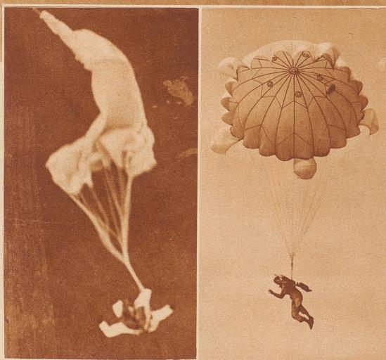
1½ Sekunden nach dem Absprung, vor der vollen Entfaltung des Fallschirms, sieht man deutlich den Öffnungs-Vorgang einer verlängerten Stoffbahn. Es sind bei diesem Fallschirm schweizerischer Konstruktion fünf solche verlängerte Stoffbahnen, die das rasche und sichere Öffnen des Fallschirms bewirken
