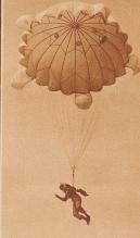
$1^{\eta_{\rm B}}$  Sekunden nach dem Absprung, vor der vollen Entfaltung des Fallschirms sicht man deutlich den Oeffnungs-Vorgang einer verlängerten Stoffbahn. Es sind bei diesem Fallschirm schweizerischer Konstruktion fünf solche verlängerte Stoffbahnen, die das rasche und sichere Oeffnen des Fallschirms bewirken
