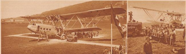
Auf dem Flugplatz Birsfelden landete am Samstagnachmittag das Riesenflugzeug «Heracles» von der Imperial Airway London. Die Rumpflänge der Maschine beträgt 27 Meter, das Gewicht 13 Tonnen. Sie wird von 4 Motoren mit 2200 Flerdekräften angetrieben und kann 38 Passagiere fassen. Seit einem Jahr versieht das Flugzeug den regelmäßigen Dienst zwischen London und Paris
