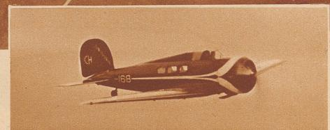
Das Fahrgestell ist eingezogen. Dazu genügt ein Hebedruck des Piloten. Der Luftwiderstand ist vermindert. Keine Strebe ist zu sehen. Zur Landung wird das Fahrgestell wieder herausgeklappt
