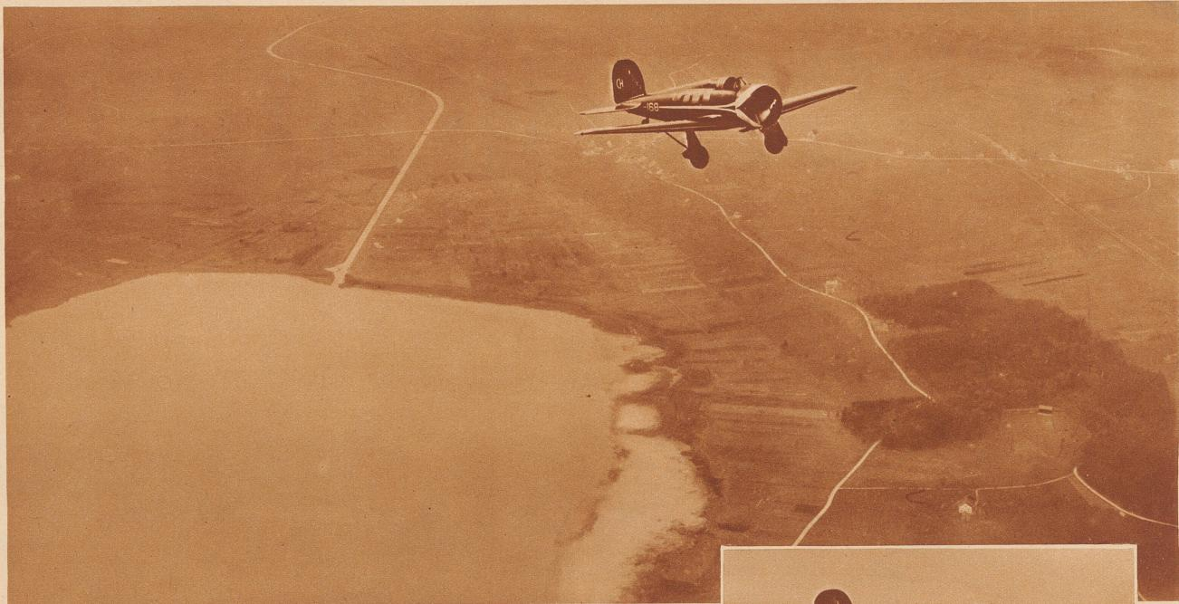
Das neue Schnellflugzeug über dem Greifensee. Das Fahrgestell ist noch sichtbar. Aber wie ein Vogel seine Beine während des Fluges an den Körper legt, kann bei diesen Flugzeugen nach dem Start das Fahrgestell eingezogen werden
