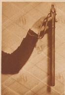
Der **Gasgummiknüppel**, der kürzlich an der Leipziger Messe von einer Berliner Waffenfabrik gezeigt wurde. An dem Gummiknüppel, der als Schlagwaffe benutzt wird, ist ein Scheintodrevolver angebracht; drückt man auf einen Hebel, dann explodiert die Gaspatrone und der Gegner wird auf eine Viertelstunde außer Kampf gesetzt
