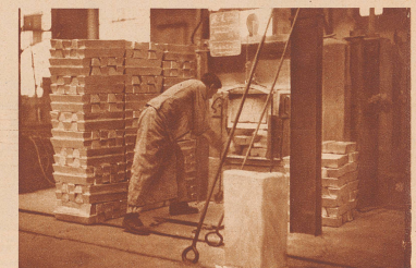
Das aus den Schmelzöfen kommende flüssige Metall wird in kleinen Gefäßen zu Barren gegossen, die man Masclen nennt. Die erkalteten Masclen kommen hernach in einen Umschmelzofen, wie das Bild zeigt. Aus diesem Ofen erst wird das Metall in genügender Einheitlichkeit gewonnen
