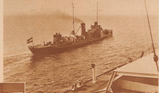
Das kleine Torpedoboot «Blitz» fernlenkt das große 10 000 Tonnen-Schiff «Zähringen» drahtlos
