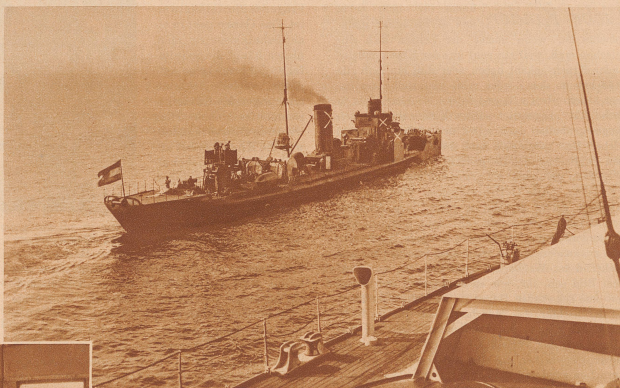
Das kleine Torpedoboot «Blitz» fernlenkt das große 10 000-Tonnen-Schiff «Zähringen» drahtlos
