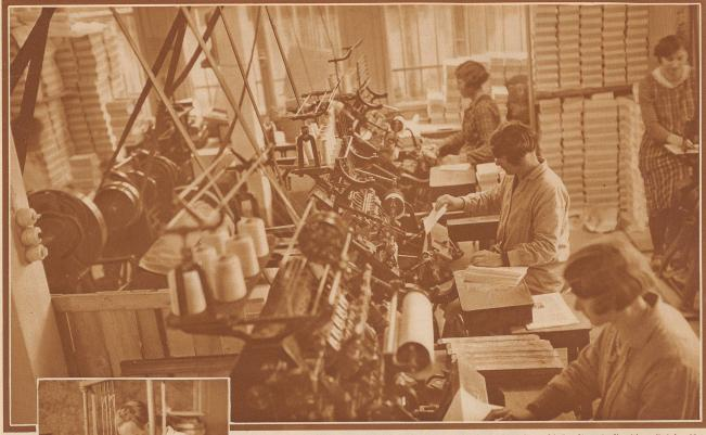
Auch in der Schweiz entwickeln sich die kleinen Handwerksbetriebe immer mehr zu fabrikmäßigen Großbetrieben. Zwischen Hand und Werk drängt sich die arbeit- und zeitsparende Maschine. So heftet zum Beispiel die Fadenbuchheftmaschine der Großbuchbinderei zwanzigmal schneller als von Hand
