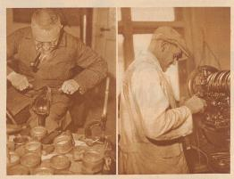
Der Schuhmachermeister, der mit einem oder zwei Gesellen in seinem Budeli an der Straße werkt, wird immer mehr durch die Fabrik verdrängt. Während er für das Rahmennähen zweier Sohlen 40-60 Minuten benötigt, ist die Doppelmaschine einer Großsohlerei in einer Minute damit fertig
