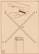
Besorgt euch zwei dünne Holzlatten von etwa einem Meter Länge; kerbt sie in der Mitte aus, wie es auf der Zeichnung gezeigt ist, und legt sie genau Mitte auf Mitte zu-sammen. Durch die Mitte wird dann ein kleiner Nagel geschlagen. Das Ende der Stäbe (a, b, c, d) wird auch eingekerbt, so wie ihr es unten seht; denn hier sollen später die Schnüre befestigt werden.
