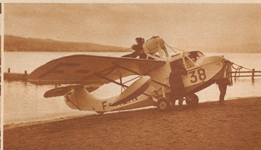
Das Amphibiumflugzeug auf dem festen Land. Die Schwimmer schweben in der Luft, auf festen Rädern wird die Maschine über den Boden gerollt Fotos Staub
