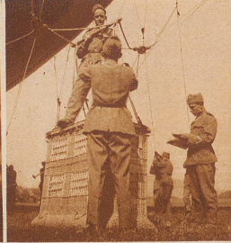
..... es gelangt die Gondel zur Montage, welche mit den vielen Instrumenten, wie Baro- meter, Thermometer, Hygrometer, Anemo- meter, Feldstecher und Photosapparat aus- gerüstet ist. Die Aufnahme hier zeigt den Korb, der nur zu Fesselballonzwecken benützt wird. Soll der Ballon motorisiert seinen Dienst er- füllen, so wird .....
