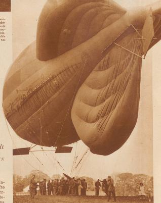
Der motorisierte Ballon startet. Die drei mächtigen Wülste an der Ballonhülle dienen zur Dämpfung der Schwingungen in der Luft, wobei man den untern als sogenannten Steuersack bezeichnet, welcher an der dem Winde zugekehrten vordern Seite mit einem Windfang versehen ist. Gegen die Gefahr des Platzens ist der Ballon durch ein Luftballonett hinreichend gesichert. Recht deutlich hebt sich das Höhensteuer ab, das in zwei breiten Flügeln über der Gondel schwebt
