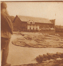
Der mit Paragummi geklebte Baumwollstoff ist als Ballonhüllenmaterial an Stelle der gefirnigten Seide getreten und wird vor der Füllung sorgfältig von der Mannschaft ausgebreitet. Da die genagelten Militärschuhe der Ballonhaut zum Verhängnis werden können, hat die Bedienung in besondern Filzschuhen zu erfolgen
