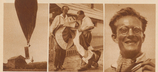
Der Ballon Piccards, mit dem ihm der Stratosphärenflug glücklich gelang, kurz nach dem Start in Aigleburg. Der Ballon ist nur zum Teil mit Gas gefüllt. Erst in großer Höhe wird er durch die Ausdehnung des Gases Kugelform annehmen. Die Flagge trägt das schweizerische Zeichen CH.
