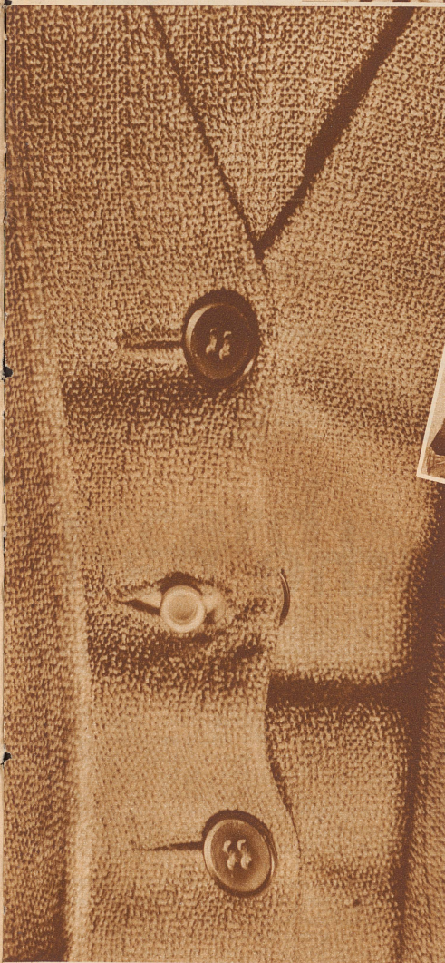
Die kleine Kamera von der Größe eines Schmuckknopfes wird vom Spion unauffällig im Knopfloch der Weste getragen
