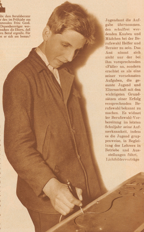
Fritz Groß führt mit einem Stift einem linearen Einschnitt in Kupfer nach. Er darf dabei nie die Randlinien berühren, sonst erfolgt elektrischer Kontakt und ein schrilles Glockensignal ertönt. Geht der Knabe vorsichtig oder ängstlich, rasch und sicher zu Werke und wie reagiert er auf das Signal? Das und noch anderes muß der Psychotechniker beobachten und daraus seine Schlüsse ziehen
