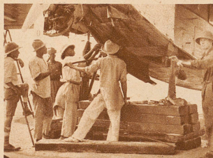
Parine! Nach dem Rückflug vom Tschadsee stand unser Fokker nach der Landung in Kano auf platten Reifen. Die Maschine muß aufgebockt werden. Landsleute helfen uns bis tief in die Nacht. Am nächsten Abend steht die Maschine wieder auf prallen Schläuchen
