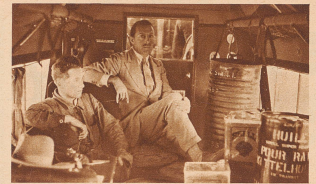
In der Luft zwischen Reggan und Gao, Um Sandstürmen und Gegenwinden gewachsen zu sein, haben wir noch vier Fässer Benzin in die Kabine hineingetragen. Kapitän Wood und Mechaniker Wegmann pumpen es in die oberen Flügeltränke. Die Luft ist dreckig, es ist schwer, die Flughöhe zu bestimmen und die Horizontalen ohne Instrumente genau einzuhalten.
