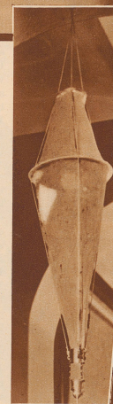
Bild rechts: Kipp-Wasserschöpfer zur Untersuchung des Meerwassers in den verschiedensten Tiefen
