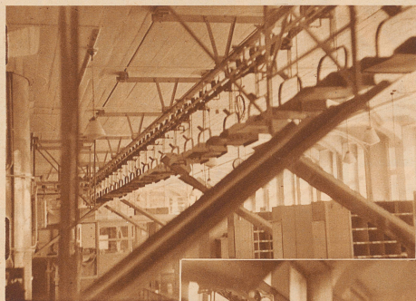
Briefversand. Von den Stellischen im Vordergrund gelangen die Briefe zu den Stempelmaschinen und dann auf der Schaukelförderanlage in die Grobsortierung im Hintergrund. Hier werden jährlich etwa 80 Millionen Briefe und viele Millionen Zeitungen verarbeitet
