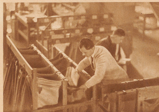
Die Versackstelle, wo die Kleinendungen für Orte und Routen in Säcke gelegt werden. Die abgeschlossenen Sendungssäcke gelangen über Spiralschienen und laufende Bänder zu den Bahnpostwagen
