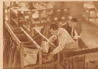
Die Versackstelle, wo die Kleinsendungen für Orte und Routen in Säcke gelegt werden. Die abgeschlossenen Sendungssäcke gelangen über Spiralschichten und laufende Bänder zu den Bahnpostwagen
