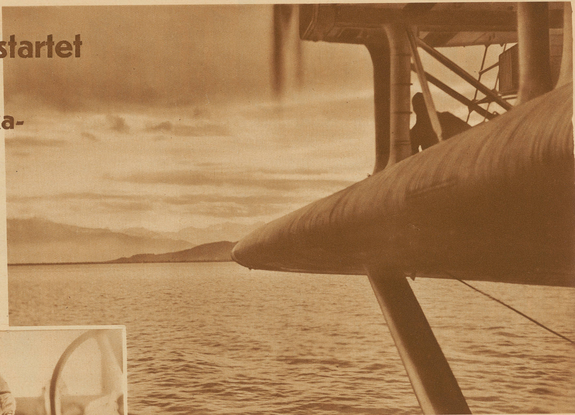
Ueber dem Bodensee. Blick von der Führerkabine auf Tragfläche und Motortürme. Die Mechaniker können auch während des Fluges zu den Motoren gelangen und eventuelle Störungen beheben
