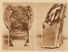
Im Falle der Gefahr öffnet sich das Polster. Der Fluggast streckt seine Arme durch die Armlöcher. Ohne seinen Platz zu verlassen, schnallt er sich das Rettungsgerät um. Dann fällt er durch den Boden der Kabine in die Tiefe. In ausreichender Entfernung von dem Flugzeug gleitet der Fallschirm aus dem Sack des Polsters. Der geöffnete Fallschirm trägt den Passagier wohlbehalten zur Erde
