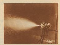
Metallisator-Pistole im Betrieb: #1 wssiger Stahl in feinster Zerteilung wird mit Preßluft aufgeschleudert
