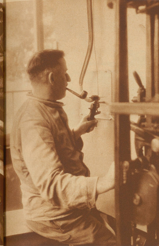
Der Handsticker am Pantograph. Er sitzt an einem Ende der Maschine, mit dem Pantograph oder Sorechsnabel über die Zeichnung fahrend. Dieser Hebel, mit der Spitze die Schablone berührend, überträgt die Stiche des Musters sechsfach verkleinert auf die Stickfläche
