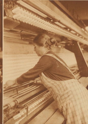
Während der Ehemann als Handsticker am Pantograph sitzt, überwacht und bedient seine Frau die Maschine. Diese arbeitet zweistöckig, mit zwei übereinanderliegenden Wagen, die je ein Stück Stoff bestücken
