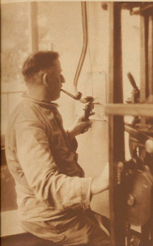
Der Handsticker am Pantograph. Er sitzt an einem Ende der Maschine, mit dem Pantograph oder Storchschnabel über die Zeichnung fahrend. Dieser Hebel, mit der Spitze die Schablone berührend, überträgt die Stiche des Musters sechsfach verkleinert auf die Stickfläche.
