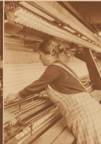
Während der Ehemann als Handsticker am Pantograph sitzt, überwacht und bedient seine Frau die Maschine. Diese arbeitet zweistöckig, mit zwei übereinanderliegenden Wagen, die je ein Stück Stoff bestöcken.
