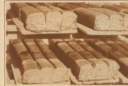
Kein Bäckergerät mit neuen Schwarzbrotzen, sondern frischer Torf, wie er die Maschine verläßt
