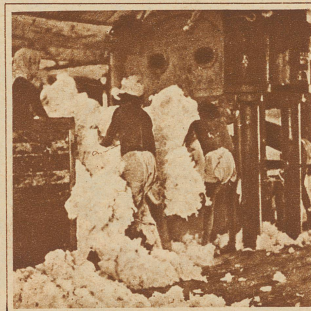
Mit einer hydraulischen Presse wird die Baumwolle zu Ballen gepreßt
