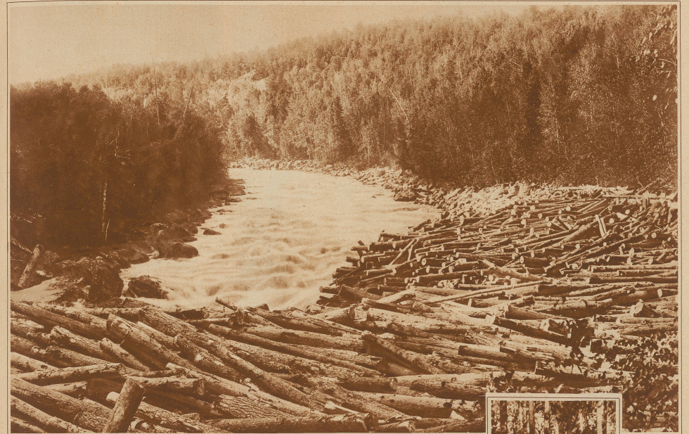
Zur Papierfabrikation bestimmtes Holz wird in den Fluß geworfen und oft erst Hunderte von Kilometer weiter unten wieder aufgefischt
