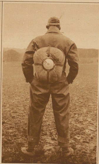
Der zusammengefaltete Fallschirm auf dem Rücken des Fliegers. Der Karabinerhaken an der Reifleine wird am Flugzeug befestigt. Springt der Flieger ab, so wird auch auf diese Weise der Schirm zum Öffnen gebracht
