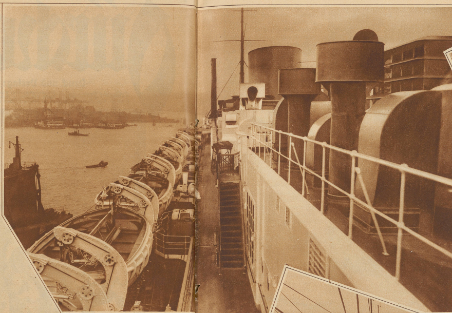
Reihe der Rettungsboote von oben. Ihre Zahl ist groß genug, daß alle 2200 Passagiere und 1000 Mann Besatzung darin Platz finden
