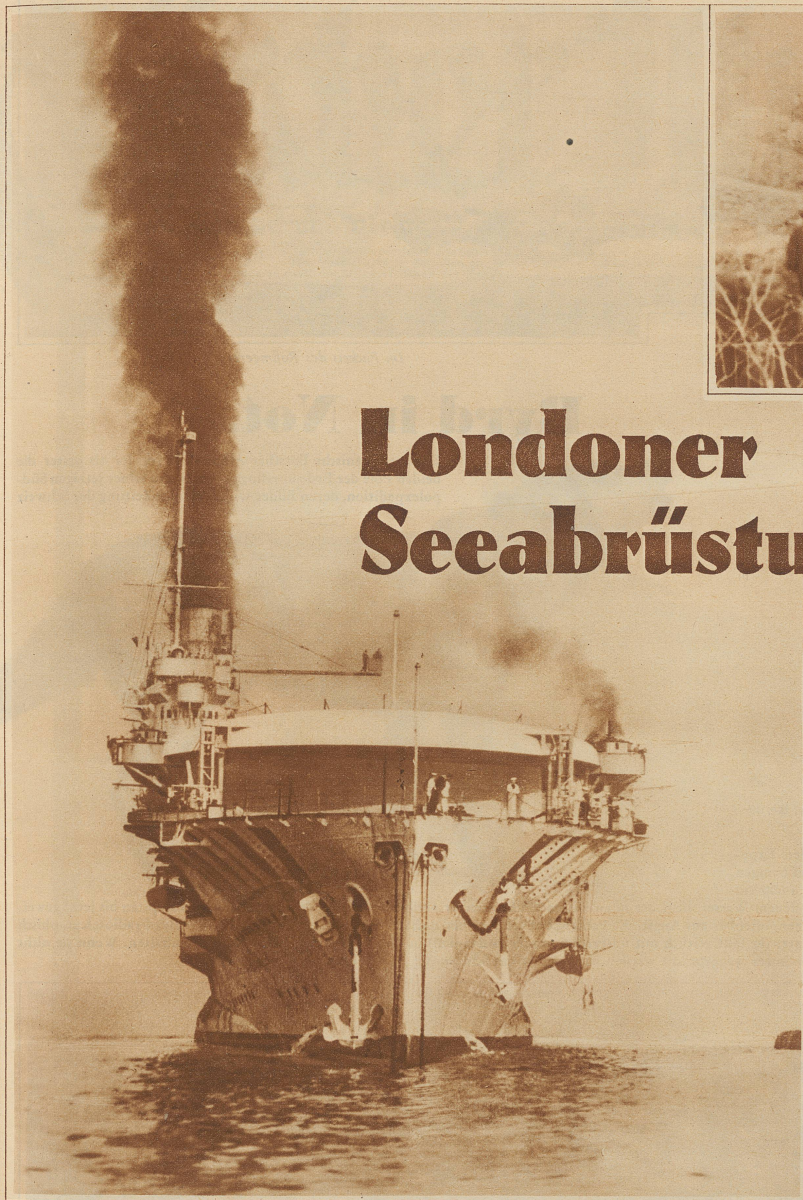
Man spricht von Abrüstung . . . Der im Kriege gebaute englische Kreuzer «Glorious» ist in ein Flugzeugmutterschiff verwandelt und neuerdings in Dienst genommen worden
