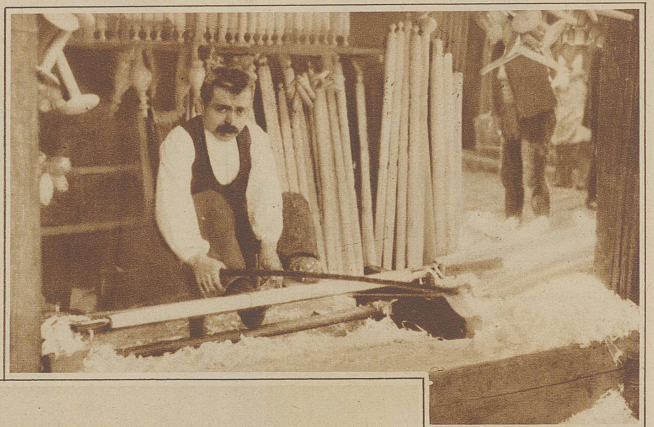
Drechsler in seiner Werkstatt, die nach der Straße offen ist. Er arbeitet in primitivster Weise, indem er die Stange mittels eines Bogens dreht und das Messer mit dem Fuß andrückt
