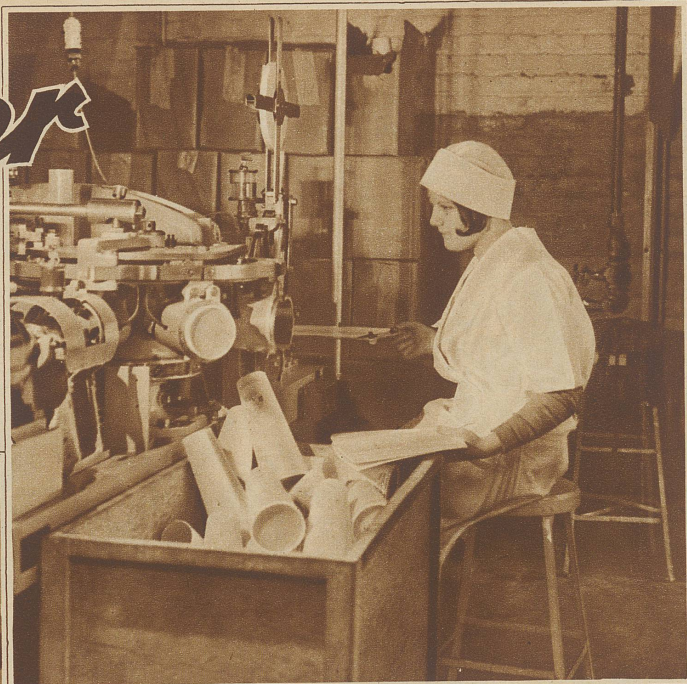
Ein Automat, der aus zugeschnittenem Papier die Flaschen formt
