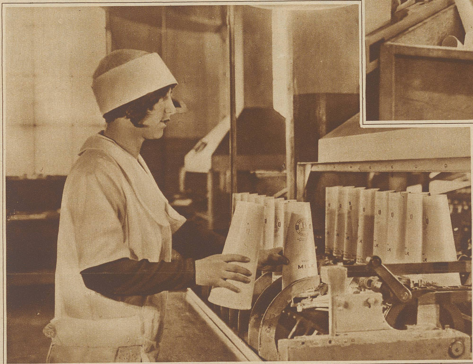
Sterilisierung durch ein Paraffinbad mit anschließender Luftkühlung
