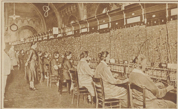
Wie ein Telephonamt mit Handbetrieb aussah
