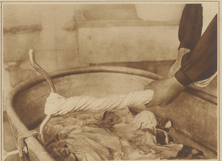
Ein praktischer, einfacher Hilfsapparat zum Auswinden von Wäsche. Der anschaubare Metallhebel ist vor kurzem als «Neuheit» in den Handel gekommen. In ihrem Prinzip war diese Einrichtung aber bereits den .... alten Ägyptern bekannt
