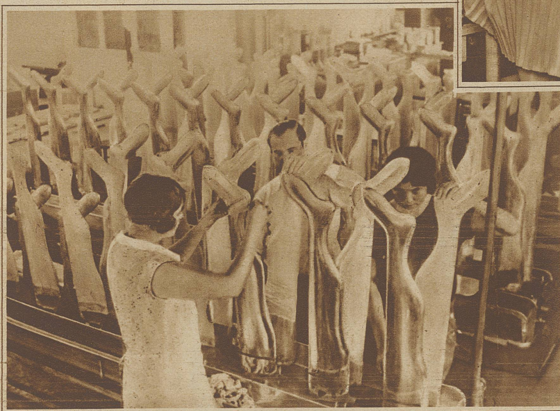
Blicke in die «Formerei» einer Strümpffabrik. Die Strümpfe werden teils über flache, teils über plastische Beinformen gezogen
