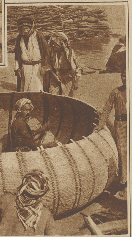
Beim Bootbauer. Die aus Dattelpalmenzweigen geflochtenen Boote vermögen, wie das obere Bild zeigt, bis zu 20 Personen zu tragen
