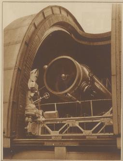
Das vordere Ende des Spiegelteleskopes der Sternwarte Berlin-Babelsberg Im Robinnern ist der schief gestellte Planspiegel ischbar, der das vom Hauptspiegel kom mende Licht in die Kastesteneinrichtung rechts wirft.
